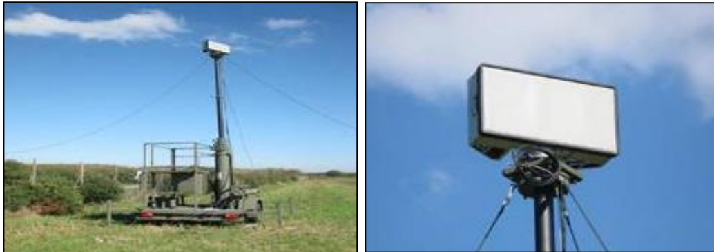
Figura 1 - Componenti Radar LYRA 10: carrello con palo telescopico e radar.
