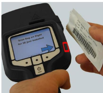
**Figura 24 – Scansione del codice a barre dell’involucro del *sensing element***
