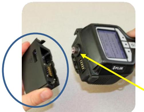
**Figura 22 – Desorbitore (a sinistra) e testa del desorbitore (a destra)**
