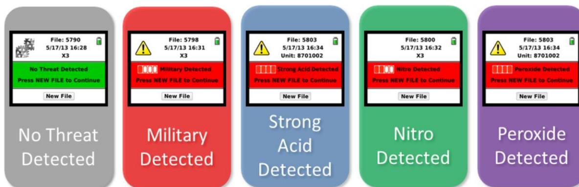
**Figura 27 – Possibili risultati del Fido X3 in configurazione per la rilevazione dei vapori**
