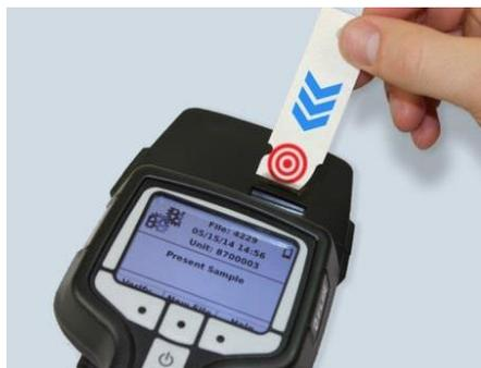
**Figura 35 – Esempio di inserimento della cartina rilevatrice nello slot del desorbitore**
