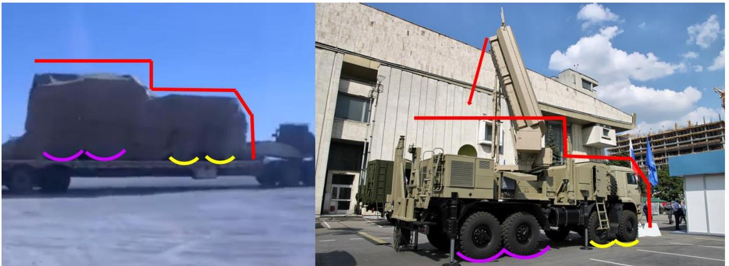
Confronto immagini tra il carico (da fonte OSINT) del secondo TIR e il radar asservito al sistema di difesa aerea Pantsir-S1
